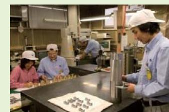
新製品を作るには、試作品が欠かせない。設計図に従い、金属を削り、表面を加工して、部品を作る。少品種で微細な加工技術を持つ企業が大田区に多い。
